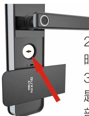
2. 插上钥匙按逆时针方向旋转360度后拔出钥匙，即可实现外部锁定功能
