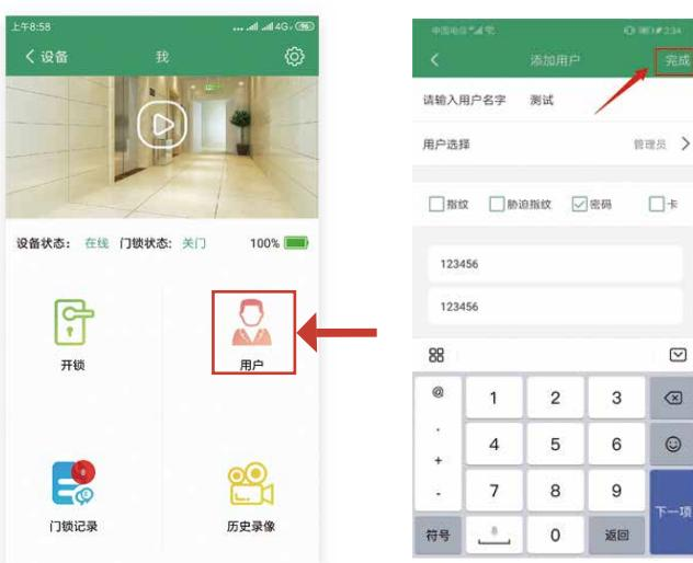
先在门锁上按“3”“#”激活门锁，设备状态显示为在线后，再进行操作
