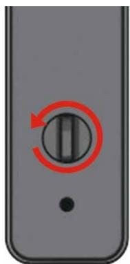
将保险旋钮逆时针方向旋转即可实现内部锁定功能
