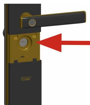
2.插上钥匙按逆时针方向旋转360度后拔出钥匙，即可实现外部锁定功能
