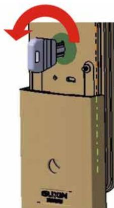
2. 插上钥匙按逆时针方向旋转360度后拔出钥匙，即可实现外部锁定功能
