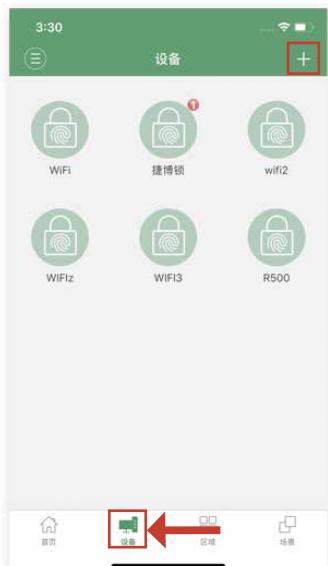
登录APP后点击下面“**设备**”图标→点击右上角“+”→弹框选择“**扫二维码添加**”→**扫描设备二维码**，APP提示添加成功返回设备页→APP弹出提示“**添加成功**”，则该设备已存在设备列表中。
