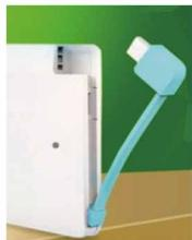
将备用电源的插头插入对应的应急插口，即可实现应急供电开锁功能
